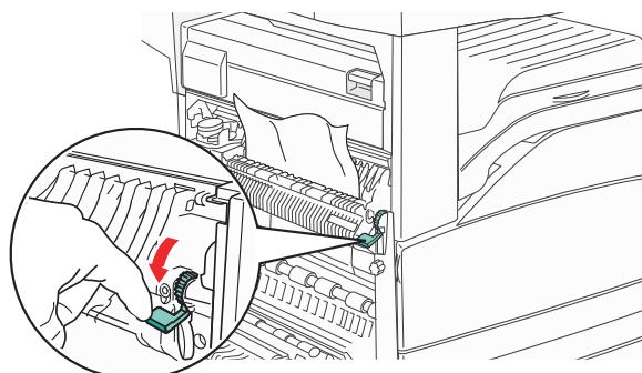
**ملاحظة:** في حالة عدم إزالة الورق المحشور على الفور، توقف عن السحب. ادفع الذراع الأخضر لأسفل واسحبه لإزالة الورق المحشور بسهولة. تأكد من إزالة جميع أجزاء الورق المحشورة.
