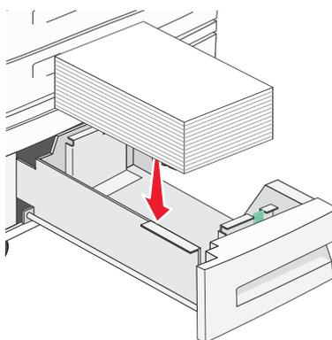
**Remarque :** assurez-vous que le papier se trouve en deçà du repère de chargement maximal du guide arrière. Une surcharge de papier risque de provoquer des brouillages.
