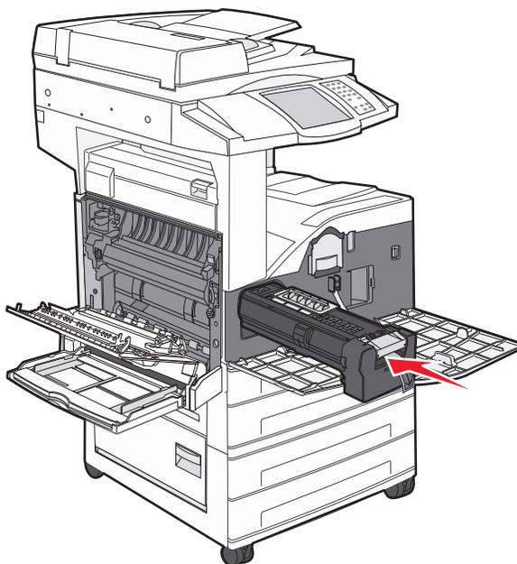
La photoconducteur s'enclenche lorsqu'il est correctement installé.
