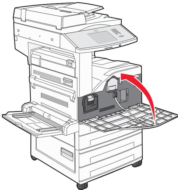
**Remarque :** une fois le photoconducteur en place et les portes fermées, l'imprimante effectue un cycle du moteur et supprime les avertissements relatifs au photoconducteur.
