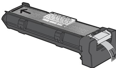
6 Alignez et insérez l'extrémité du photoconducteur.
