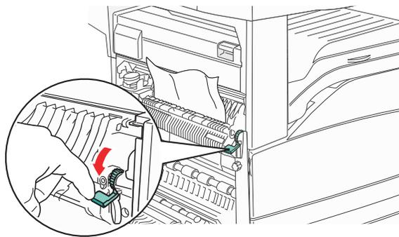
**注意：** 如果卡纸没有立即移动，请停止拉动。向下推并拉住绿色控制杆，使之较容易地取出卡纸。确认已取出所有纸张碎片。
