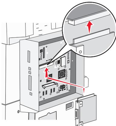
5 用力将内置式打印服务器或接口卡推入系统板上的卡连接器中。
