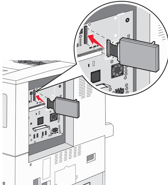
6 将硬盘翻转过来，然后将固定板上的三个小柱压入系统板上的孔中。硬盘咬合到位。
