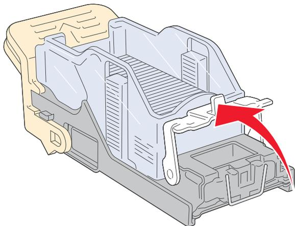
**5** 通过订书钉盒支架底部的透明盖板进行观察，确认入口处没有被卡的订书钉。
