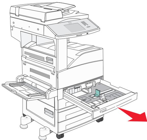
2 压住宽度和长度导片并将它们滑动到与加载的纸张尺寸相符的正确位置上。
