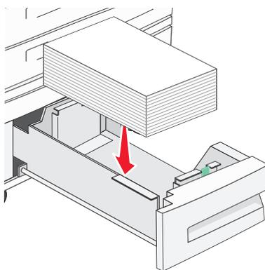
**注意：**确认纸张低于后部导片上的最大加载线。过量加载可能造成卡纸。
