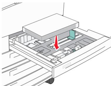
**5** 确认纸张导片牢固地靠着纸张边缘。
