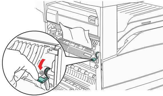
**注意：**如果卡纸没有立即移动，请停止拉动。向下推并拉住绿色控制杆，使之较容易地取出卡纸。确认已取出所有纸张碎片。
