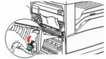
ملاحظة: إذا لم يتحرك الورق المحشور على الفور، فتوقف عن السحب. ادفع لأسفل واسحب الذراع الأخضر حتى تجعل إزالة الانحشار أكثر سهولة. تأكد من إزالة جميع أجزاء الورق المحشورة.
