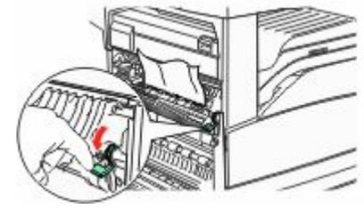
ملاحظة: إذا لم يتحرك الورق المحشور على الفور، فتوقف عن السحب. ادفع لأسفل واسحب الذراع الأخضر حتى تجعل إزالة الانحشار أكثر سهولة. تأكد من إزالة جميع أجزاء الورق المحشورة.
