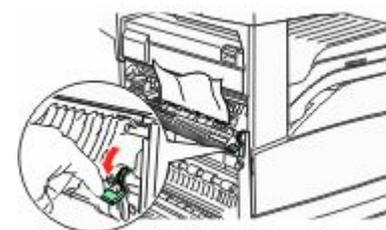
**注意：** 如果卡纸没有立即移动，请停止拉动。向下推并拉住绿色控制杆，使卡纸较容易被取出。确认已取出所有纸张碎片。
