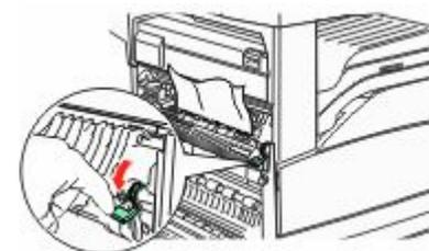
**注意：** 如果卡纸没有立即移动，请停止拉动。向下推并拉住绿色控制杆，使卡纸较容易被取出。确认已取出所有纸张碎片。
