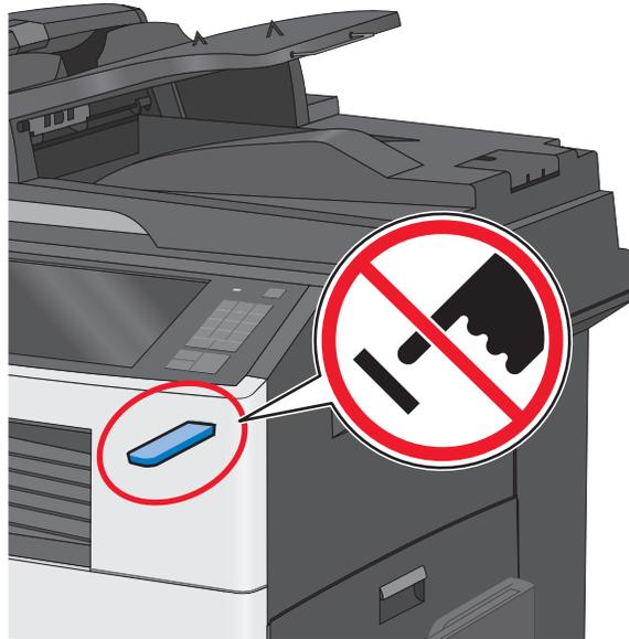
**Warnung - Mögliche Schäden:** USB-Kabel, Netzwerkadapter, Anschlüsse, Speichermedium oder Drucker sollten im angezeigten Bereich während eines Druck-, Lese- oder Schreibvorgangs mittels Speichermedium nicht berührt werden. Es kann ein Datenverlust auftreten.
