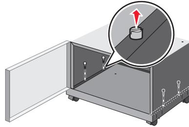
**b** 将打印机工作台的上面部分抬离基座。
