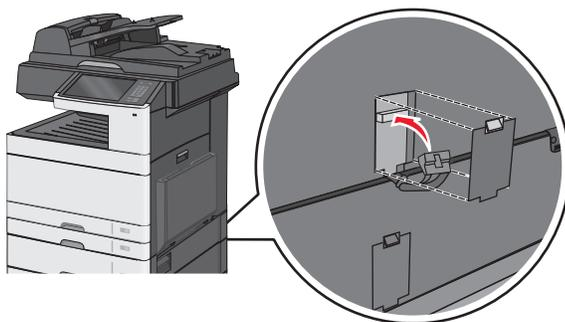
**9** 将支架安装到打印机和纸匣选件的背后。
