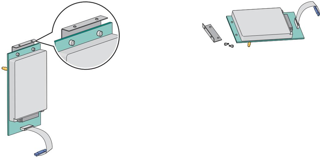
3 将打印机硬盘接口电缆的插头连接到 ISP 板的插座中。
