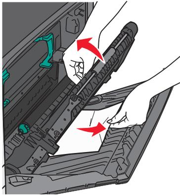
3 关闭双面打印部件上的盖板。
