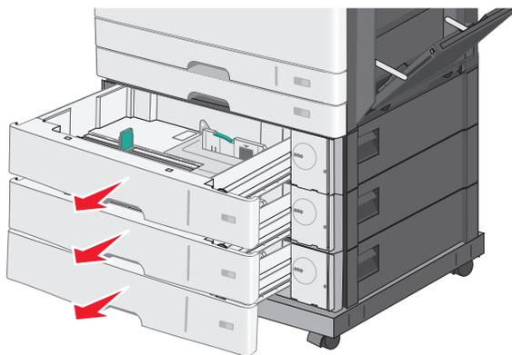
**b** 进入下部进纸匣选件内部并插入螺钉，将它向上推到它上方的进纸匣选件。
