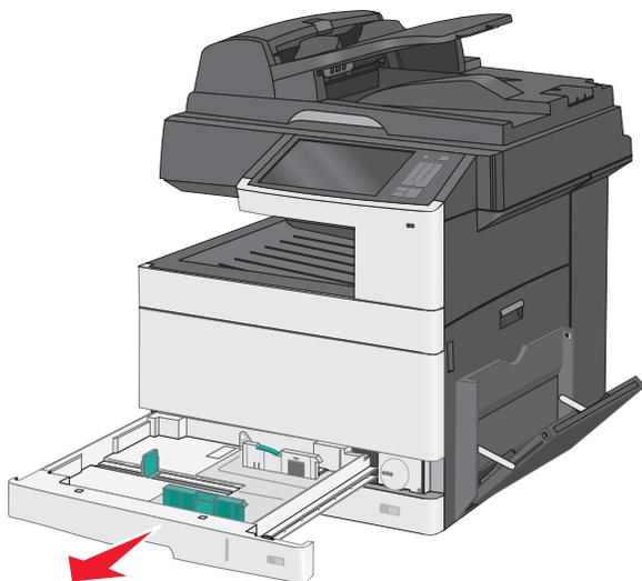
请注意进纸匣底部的尺寸指示器。请使用这些指示器来帮助放置导片。
