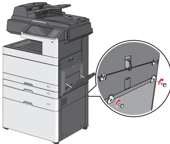
**c** 将支架插入位于打印机和进纸匣选件背后的插槽中。
