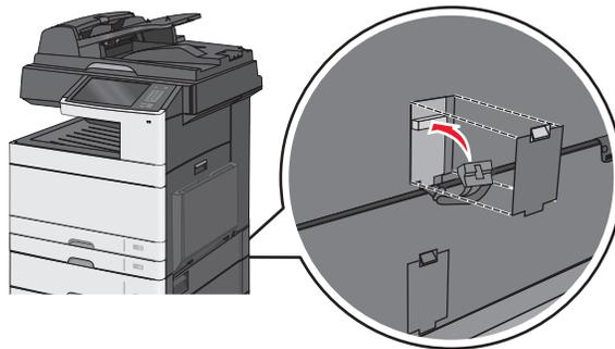
**8** 将支架安装到打印机、进纸匣选件和打印机工作台的背后。
