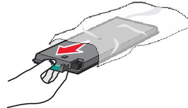
6 将新的废碳粉瓶插入打印机中。
