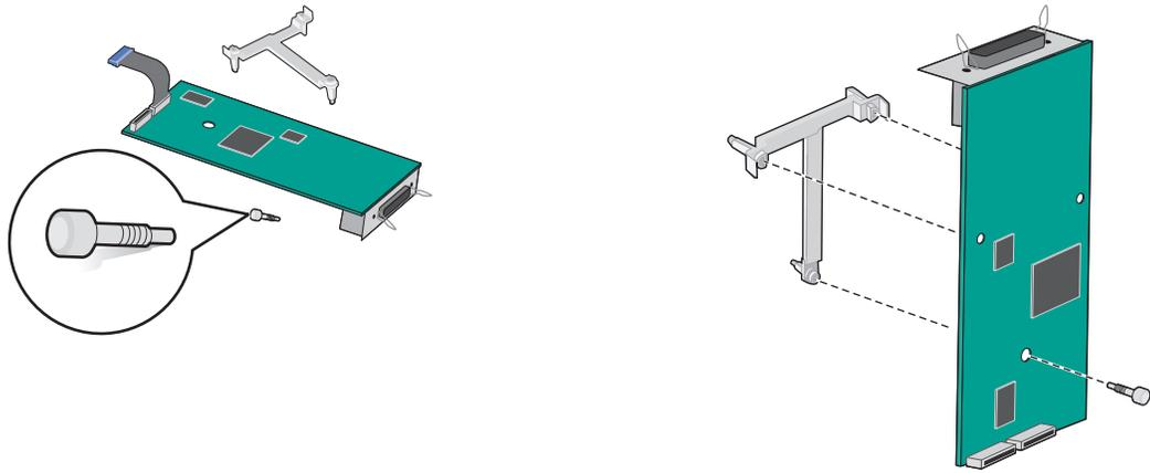
**6** 使用提供的螺钉将 ISP 解决方案连接到系统板机箱上。
