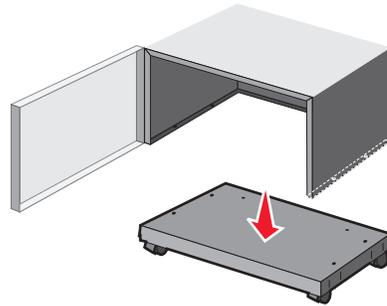
**4** 将翼形螺钉连接到带脚轮基座上。
