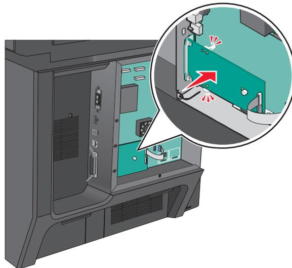
7 将 ISP 解决方案接口电缆连接到系统板的插座中。
