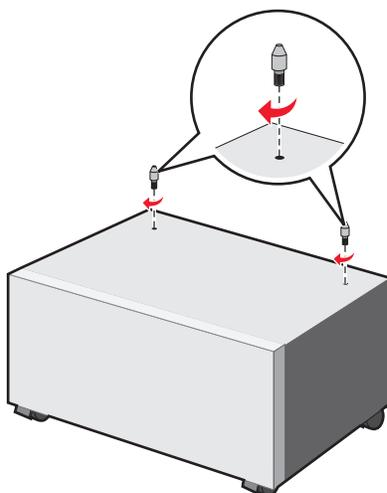
4 将进纸匣选件与打印机工作台对齐，然后将打印机向下放到进纸匣上。
