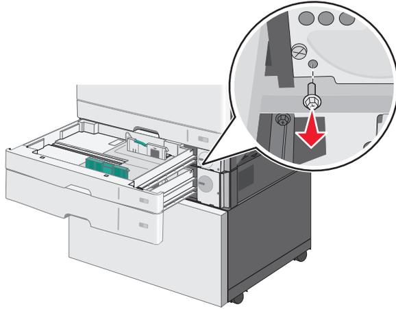
**c** 将支架放在螺钉孔上，并用螺钉固定它。
