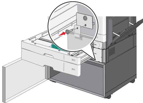
**d** 关闭进纸匣选件和打印机工作台。
