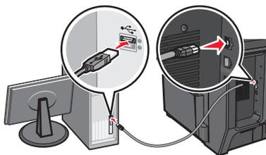
**注意：** 打印机被配置后，软件将指导您断开临时的 **USB 电缆** 连接，这样您就可以实现无线打印。
