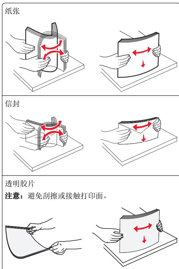
4 加载纸张或特殊介质。将纸堆轻轻地滑入多功能进纸器中，直到到达挡纸板。
