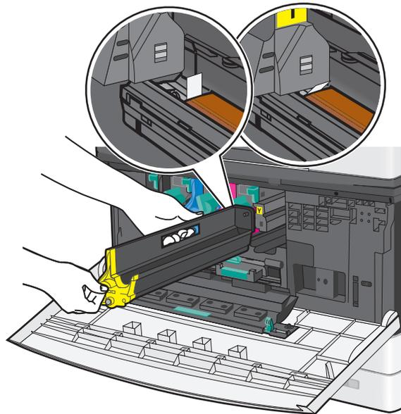
a 将成像部件插入打印机中，直到它发出咔嚓一声，卡入到位。
