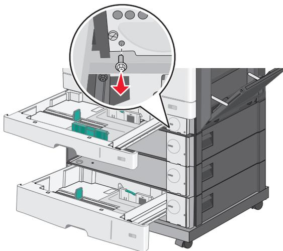
**c** 将支架放在螺钉孔上，并用螺钉固定它。
