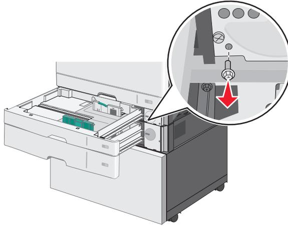
**c** 將支架跨座在螺絲孔上，然後用螺絲將它鎖緊。
