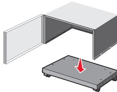
**4** 將手旋螺絲鎖到腳輪底座上。
