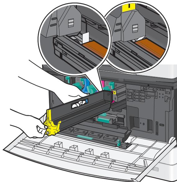
a 將成像組件插入印表機，直到它發出喀嚓一聲，卡入定位。
