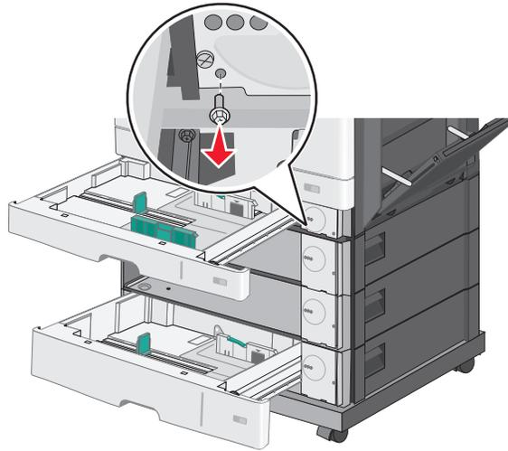
**c** 將支架跨座在螺絲孔上，然後用螺絲將它鎖緊。
