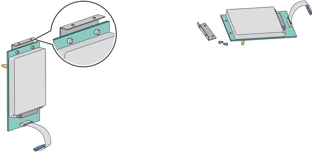
3 將印表機硬碟介面電纜連接至 ISP 機板上的連結器。
