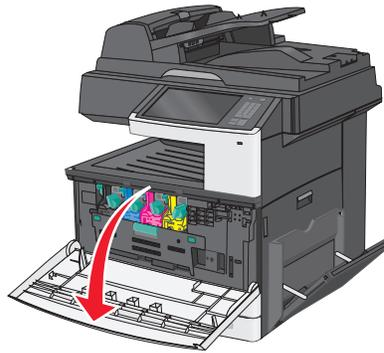
**警告—潛在損害：**為了避免成像組件曝光過久，門板打開的時間不要超過 10 分鐘。
