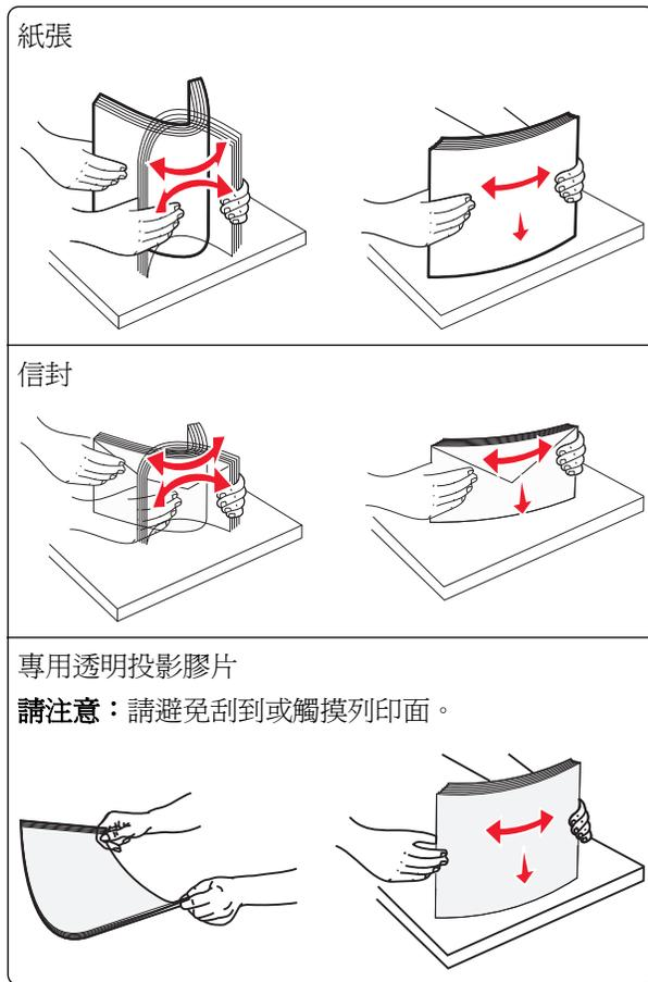
4 載入紙張或特殊材質。將整疊列印材質輕輕滑入多用途送紙器中，直到抵住為止。
