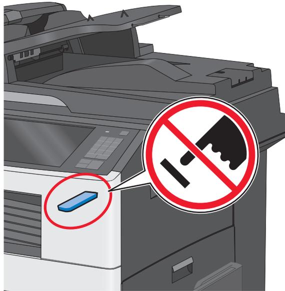
**警告—潛在損害：**若目前正從記憶體裝置進行列印、讀取或寫入作業，請勿碰觸 **USB 電纜**、任何網路配接卡、任何接頭、記憶體裝置或圖中所顯示的印表機區域。這麼做可能會導致資料遺失。
