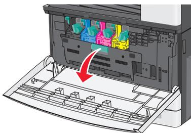
3 推入成像組件鎖定壓桿讓它往上彈，再將附有碳粉匣的成像組件往外拉。
