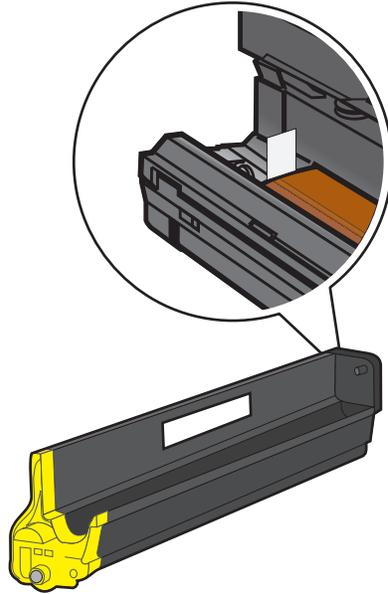
5 重新安裝成像組件。將成像組件插入印表機時，LED 擦拭器會刷過整列的 LED，藉此清潔列印頭鏡片。
