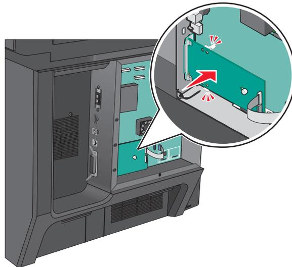
7 將 ISP 解決方案介面電纜連接至系統主機板上的連結器。
