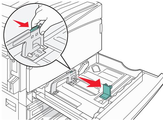
**Nota:** utilice los indicadores de tamaño de la parte inferior de la bandeja como ayuda para la colocación de las guías.
