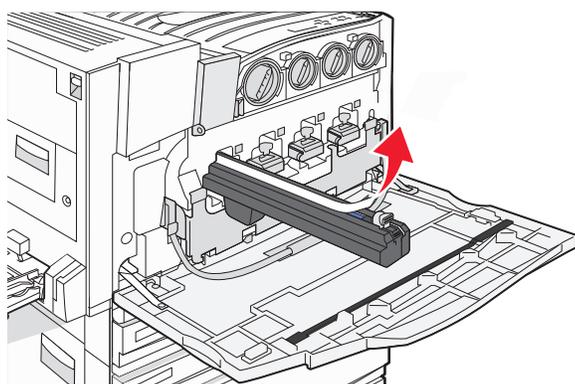
7 Empuje el botón para introducir el fotoconductor mientras extrae la cubierta.
