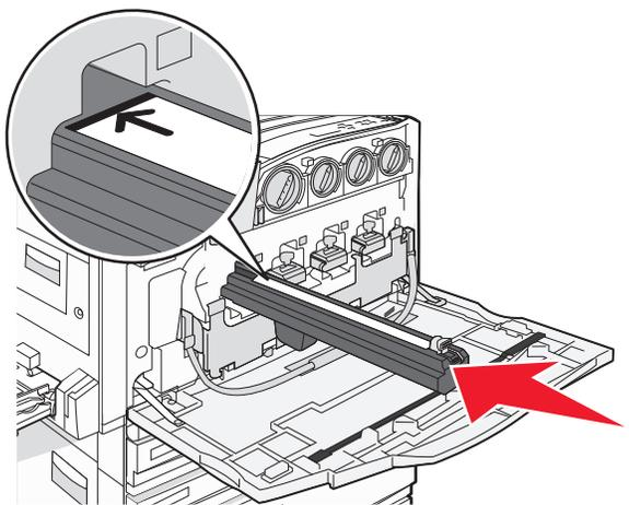
6 Retire la cinta de la parte superior del fotoconductor.
