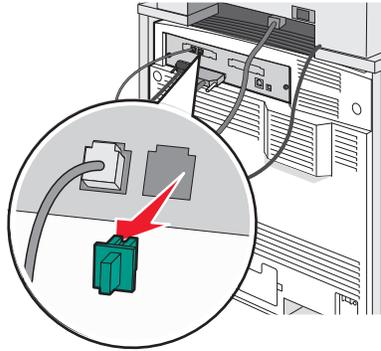
**Nota:** una vez retirado este enchufe, cualquier equipo específico para un país o región que se conecte a la impresora mediante un adaptador tal y como se muestra, no funcionará correctamente.
