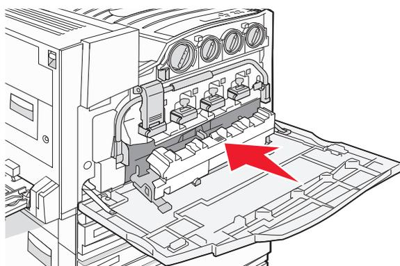
**10** Coloque el limpiador de lentes del cabezal de impresión en las muescas de la puerta E.
