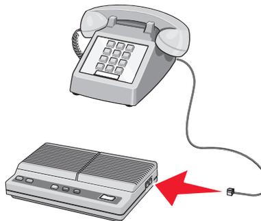
5 Conecte un tercer cable telefónico del contestador automático al puerto EXT ☎ de la impresora.
