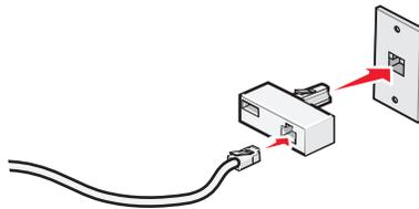
**Nota:** se muestra el adaptador para el Reino Unido. Su adaptador puede que tenga un aspecto diferente, pero encajará en la toma de salida telefónica de su ubicación.
