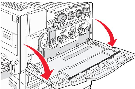
**4** Retire el cartucho especificado girándolo hacia la izquierda hasta que la palanca con forma de flecha apunte hacia el símbolo de desbloqueo.
