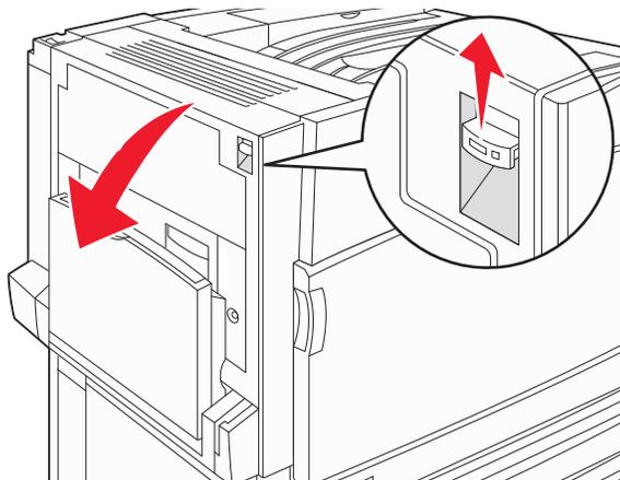
**2** Levante la palanca verde y tire del papel hacia afuera y arriba.
