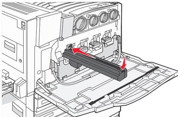
8 Levante la barra y empuje el pestillo E5 para que la barra quede fija en esa posición.
