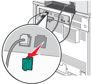
4 Conecte un segundo cable telefónico del teléfono al contestador automático.
