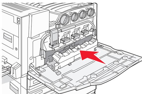
**9** Coloque el limpiador de lentes del cabezal de impresión en las muescas de la puerta E.
