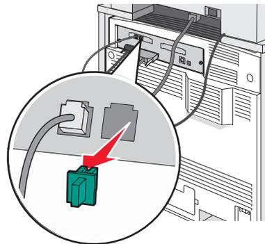
**4** Conecte um segundo cabo de telefone ao telefone e ao computador com modem.
