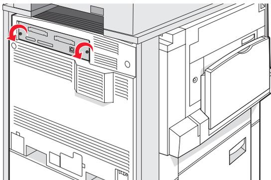
b Puxe cuidadosamente a tampa e a placa do sistema para fora da impressora e remova-as.
