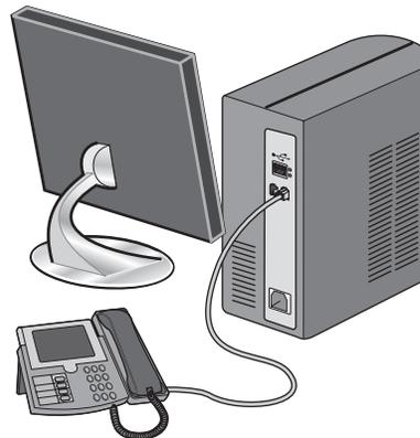
**5** Conecte um terceiro cabo de telefone ao computador com modem e à porta EXT
