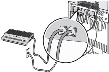
**Nota:** Depois de removido o plugue, nenhum equipamento específico de país ou região conectado à impressora por meio do adaptador, como mostrado, funcionará corretamente.
