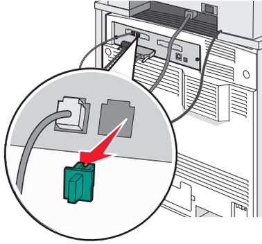
4 Conecte o outro cabo de telefone a um telefone e conecte-o à porta EXT ☎ da impressora.
