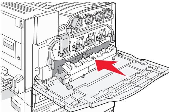
**9** Coloque o limpador da lente da cabeça de impressão nos entalhes da Porta E.
