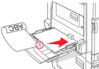
**Nota:** Coloque o papel timbrado com a face voltada para baixo no alimentador multifunção e com a borda longa do papel entrando primeiro na impressora.
