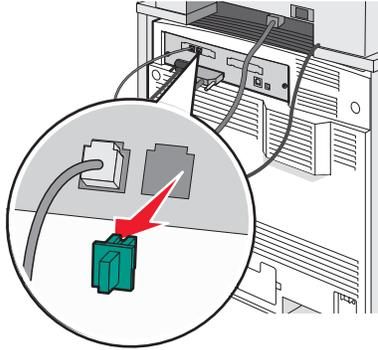
**Nota:** Depois de removido o plugue, nenhum equipamento específico de país ou região conectado à impressora por meio do adaptador, como mostrado, funcionará corretamente.
