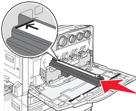
**6** Remova a fita da parte superior do fotocondutor.
