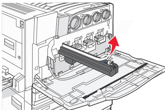
**7** Pressione o botão para frente para inserir o fotocondutor enquanto remove a proteção.
