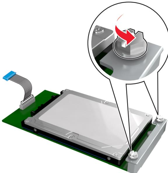
**b** 将打印机硬盘接口电缆的插头插入控制器板的插座中。
