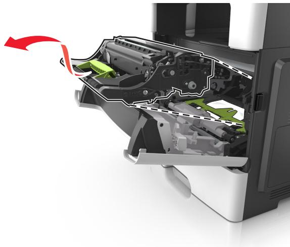
**警告—可能的损坏：**请勿触摸成像部件下面发亮的蓝色感光鼓。否则会影响以后打印作业的质量。
