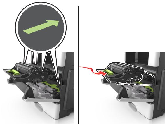
8 将碳粉盒的侧导轨与打印机内部侧导轨上的箭头对齐，然后将碳粉盒插入打印机中。
