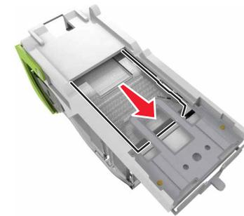
**Hinweis:** Wenn sich die Heftklammern an der Rückseite der Tonerkassette befinden, schütteln Sie die Kassette nach unten, um die Heftklammern in die Nähe der Metallhalterung zu bringen.
