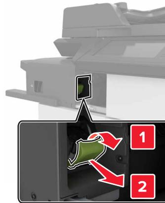
4 Heben Sie den Heftklammerschutz mit Hilfe der Metallasche hoch, und entfernen Sie anschließend alle losen Heftklammern.
