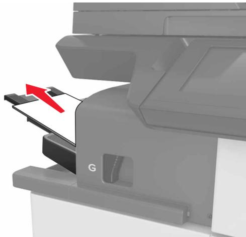
2 Drücken Sie die Verriegelung und schieben Sie den Heftklammer-Finisher nach links und entfernen Sie das gestaute Papier.
