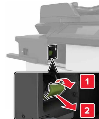
4 Utilize a guia de metal para elevar a proteção de grampos e, em seguida, remova qualquer grampo solto.
