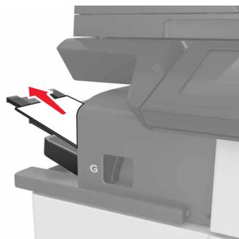
2 Pressione a trava no encadernador e, em seguida, deslize o encadernador para a esquerda.
