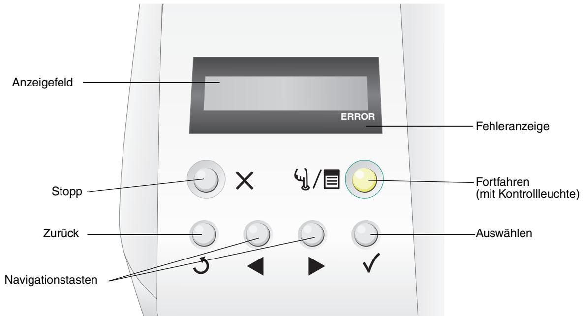
In der folgenden Tabelle wird die Verwendung der Tasten und der Aufbau der Bedienerkonsole beschrieben.
