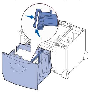
3 Presione las dos palancas de la guía lateral y deslice la guía hacia la posición que corresponda con el tamaño del papel cargado.
