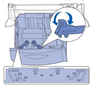
4 Deslice el soporte inferior hacia la parte frontal de la bandeja hasta que toque la guía frontal.
