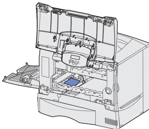
**9** 将图象传输部件插回打印机中。
