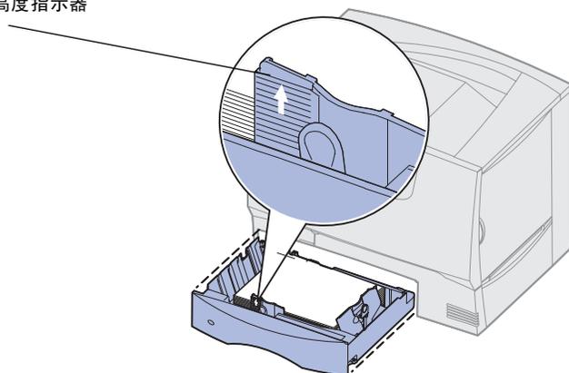
注意： 不要超过最大纸堆高度限制。过量加载进纸匣可能会造成卡纸。
