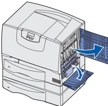
**切记：** 熔印配件的温度可能很高。在继续进行操作之前，先让它冷却下来。
