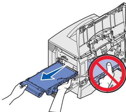
**8** 查看打印机内部。取出所有破损的纸张或其它卡纸。
