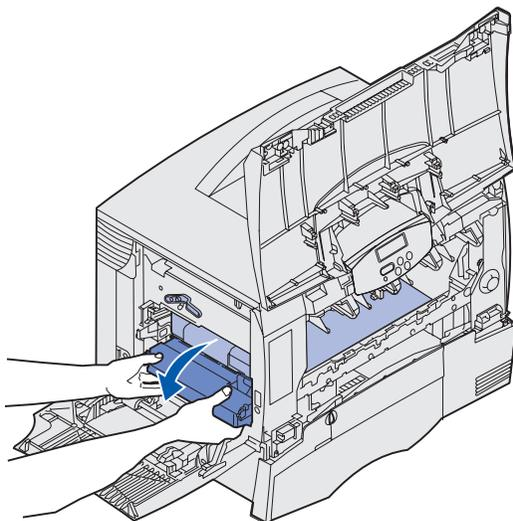
**c** 将图象传输部件滑出打印机并将它放在干净、平坦的表面上。
