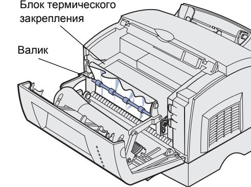
**ВНИМАНИЕ!** Блок термического закрепления нагревается до высокой температуры!
