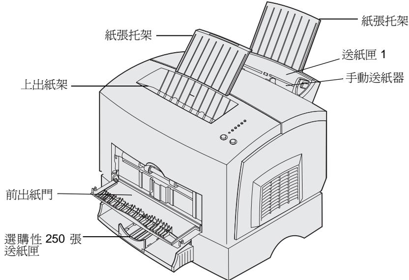
印表機頂層の出紙架最多可容納 100 張紙。單張前出紙門備有直通式送紙路徑，可供特殊材質列印用（特殊材質包括：專用透明投影膠片、信封、貼紙、卡片或索引卡），透過這種方式可減少紙張扭曲與夾紙的可能性。
