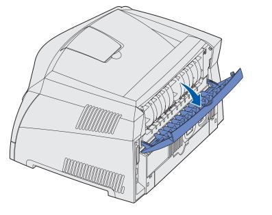
При открытой дверце заднего выходного лотка все материалы для печати выдаются в задний лоток. При закрытой дверце заднего выходного лотка все материалы для печати выдаются в выходной лоток сверху принтера.
