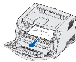
4 Поднимите щиток на передней части принтера и удалите всю бумагу, замятую под щитком.
