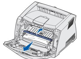
5 Откройте задний выходной лоток и удалите всю замятую
