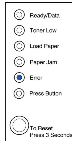
Die obere Druckerabdeckung ist geöffnet, oder die Druckkassette ist nicht eingesetzt.
