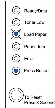
Viene visualizzato un messaggio che richiede di caricare un singolo foglio nell'alimentatore manuale.
