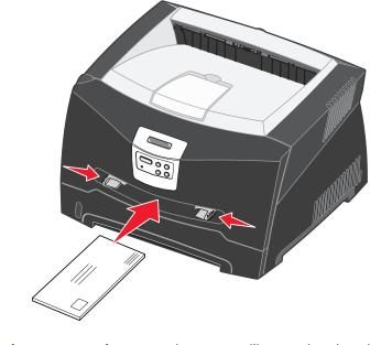
Avertissement :ne forcez pas le support d'impression dans le chargeur. Vous risqueriez de provoquer un bourrage
