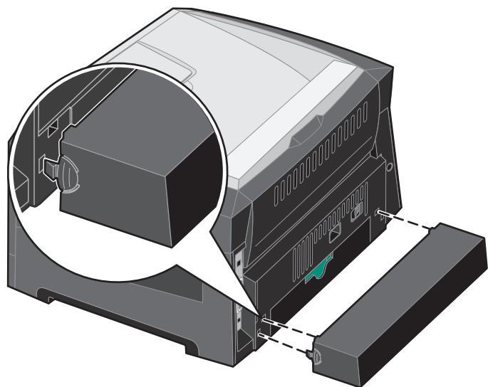
Подсоедините дополнительный пылезащитный чехол к задней панели принтера; для этого следует совместить выступы на чехле с отверстиями на принтере, а затем нажать на чехол до защелкивания в фиксаторах.
