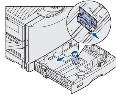
По расположению левой направляющей принтер определяет формат загруженной в лоток бумаги.
