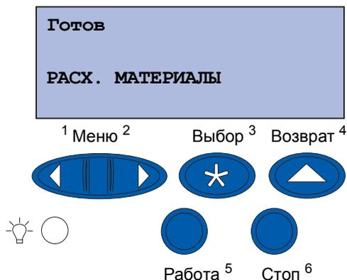
Счетчик принтера ведет учет данных о картриджах с тонером, фотобарабанах, очистителе термоблока, термоблоке и ленте переноса изображения. Когда ресурс одного из этих устройств заканчивается или выработан полностью, на дисплей выводится соответственно сообщение **Заканчивается**, **Закончился** либо **Заканчивается ресурс** или **Ресурс исчерпан**.
