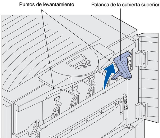
**3** Gire la palanca de bloqueo de la cubierta superior hacia la derecha.
