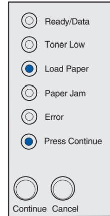
Cuando la luz Cargar papel y Pulsar Continuar están fijas, la impresora se ha quedado sin material de impresión o el material de impresión no se ha cargado correctamente.
