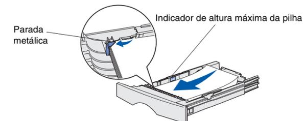
**Nota:** Não exceda a altura máxima da pilha. O excesso de papel na bandeja pode causar atolamento.
