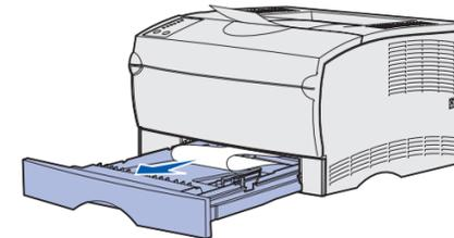
Se você vir uma mídia de impressão sobre a parada metálica, remova completamente a bandeja. Pressione a mídia de impressão para baixo para travar a chapa metálica em sua posição. Reposicione a mídia de impressão sob a parada metálica.
