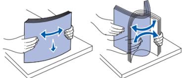
6 Posizionare la risma dei supporti di stampa accostandola al lato sinistro del vassoio, inserirla sotto il fermo di metallo con il lato di stampa rivolto verso il basso e orientata verso la parte anteriore del vassoio. Non piegare o arricciare i fogli.
