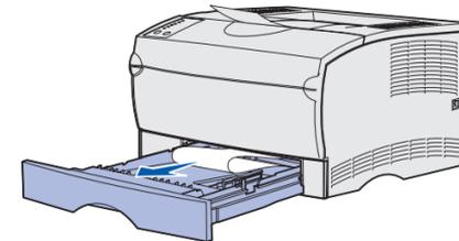
Se si notano supporti di stampa sopra il fermo di metallo, rimuovere completamente il vassoio. Premere i supporti di stampa finché la piastrina metallica sottostante non scatta in posizione. Reinserrire i supporti di stampa sotto il fermo di metallo.
