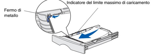
**Nota:** Non superare il limite massimo di caricamento indicato. Un caricamento eccessivo del vassoio potrebbe provocare un inceppamento.
