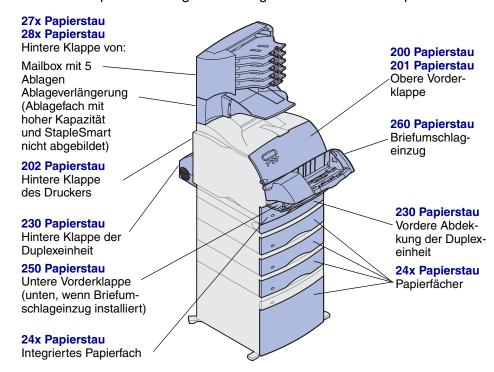
Warnung: Versuchen Sie nicht, Papierstaus mit Hilfe von Werkzeugen zu beseitigen. Hierdurch kann der Drucker dauerhaft beschädigt werden.
