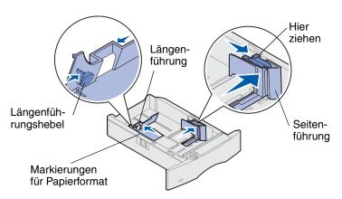
Befolgen Sie diese Anweisungen, um Druckmedien in eines der Standard- oder der optionalen Papierfächer einzulegen. Das Papier wird in alle Papierfächer auf die gleiche Weise eingelegt.
