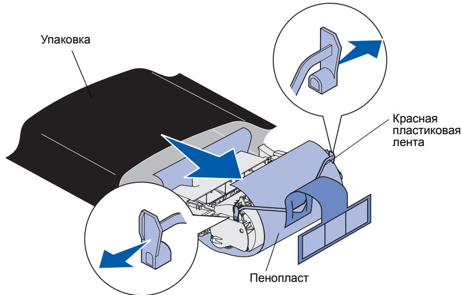
**Предупреждение.** Не прикасайтесь к поверхности фотоэлектрического барабана, открытой в нижней части картриджа.
