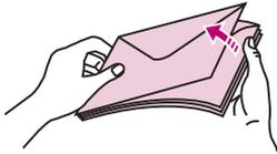
6 Gleichen Sie die Kanten auf einer ebenen Fläche an. Drücken Sie die Ecken nach unten, um sie zu glätten. Fächern Sie die Briefhüllen auf. Auf diese Weise wird verhindert, daß die Kanten der Briefhüllen zusammenkleben, damit sie ordnungsgemäß eingezogen werden können.
