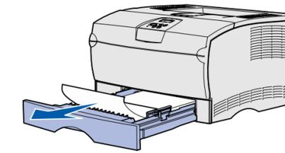
Wenn Sie feststellen, daß sich Druckmedien oberhalb des Metallanschlags befinden, nehmen Sie das Fach vollständig heraus. Drücken Sie die Druckmedien nach unten, so daß die darunterliegende Metallplatte eingerastet. Nehmen Sie die Druckmedien heraus, und legen Sie sie wieder unter den Metallanschlag ein.
