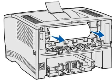
**Hinweis:** Sie müssen möglicherweise die Druckkassette herausnehmen, um einen Papierstau in diesem Bereich zu beseitigen.
