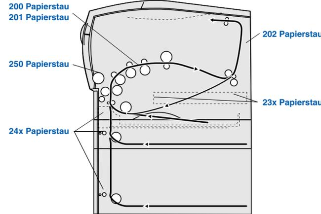
**Hinweis:** Um die Fehlermeldung **Papierstau** zu löschen, müssen Sie alle gestauten Druckmedien aus dem gesamten Papierweg entfernen; wählen Sie anschließend **Fortfahren** aus.
