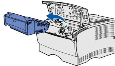
**Warnung:** Berühren Sie nicht die Fotoleitertrommel an der Unterseite der Druckkassette.
