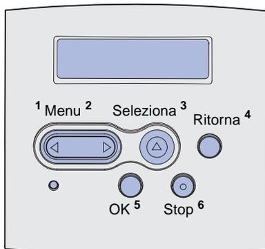
Il pannello operatore dispone di un display a cristalli liquidi (LCD) di due righe di sedici caratteri ciascuna, cinque pulsanti e una spia luminosa che lampeggia quando è in corso l'elaborazione di un processo; tale operazione è indicata dal messaggio **Occupata**.
