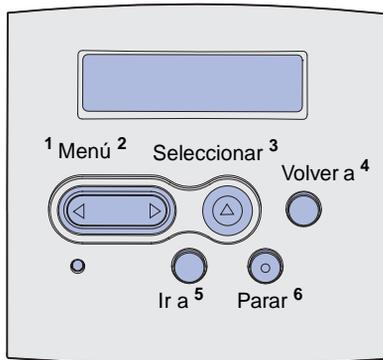
El panel del operador tiene una pantalla de cristal líquido (LCD) de 2 líneas de 16 caracteres, cinco botones y un indicador que parpadea cuando la impresora está procesando un trabajo y aparece el mensaje **Ocupada**.
