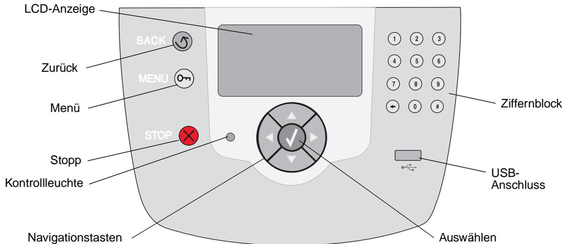
In der folgenden Tabelle wird die Verwendung der Tasten und der Aufbau der Anzeige beschrieben.
