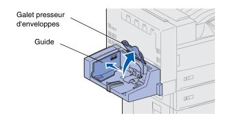
3 Placez les enveloppes le long du côté droit du chargeur d'enveloppes, face vers le bas, rabat vers le haut. Les étiquettes indiquent la taille des enveloppes, l'orientation et la hauteur maximale de la pile.
