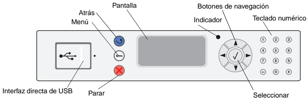
En la tabla siguiente se describe el uso de los botones y el diseño de la pantalla del panel del operador.
