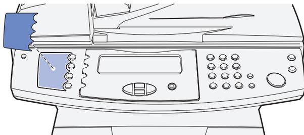
Si vous n'utilisez pas l'anglais comme langue par défaut et si vous disposez de la plaquette signalétique de la langue du panneau de commande du MFP, fixez-la au panneau de commande de l'appareil.
