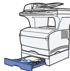
Si ve algún material de impresión sobre el tope metálico, extraiga completamente la bandeja. Presione hacia abajo el material de impresión para que la placa metálica situada bajo él quede fija en su lugar. Vuelva a colocar el material de impresión bajo el tope metálico.
